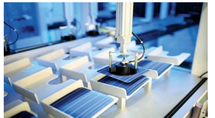
通威太阳能智能制造生产车间成品电池自动分选
